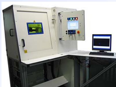
Mikroschweissanlage mit Faserlaser und Vision System
