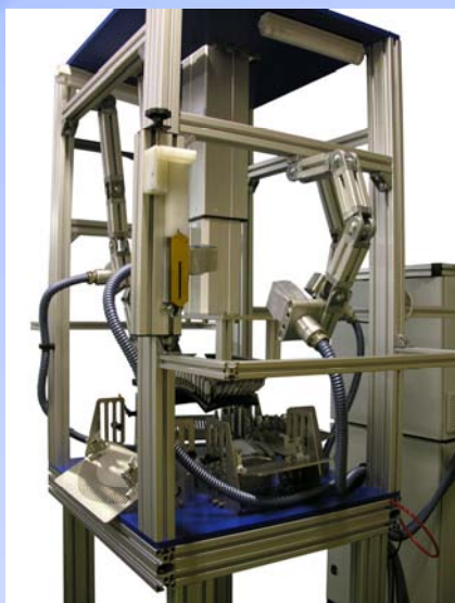
Schweissanlage mit vier Laserköpfen auf Gelenkarmen
