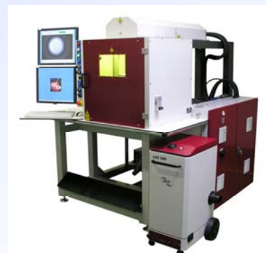
Lasieranlage für Tiefenmarkierung mit integrierter Absaugung
